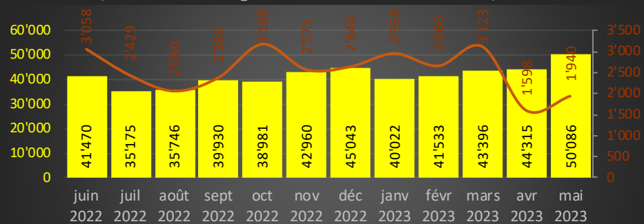
production de biogaz et volume de boue valorisée par mois
